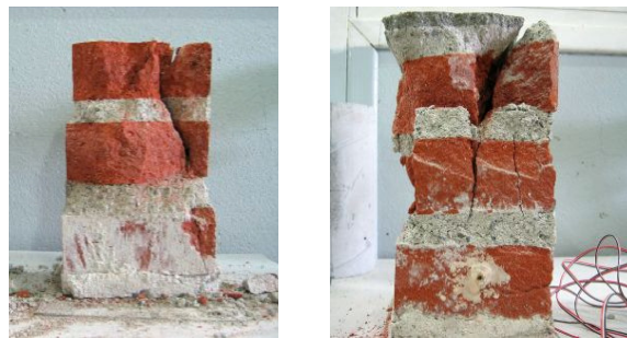
Figure 49 - Essais sur sandwiches. Photos après rupture.
