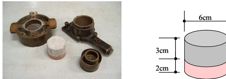
Figure 67 - Dispositif d'essai de cisaillement de l'interface brique - mortier.
