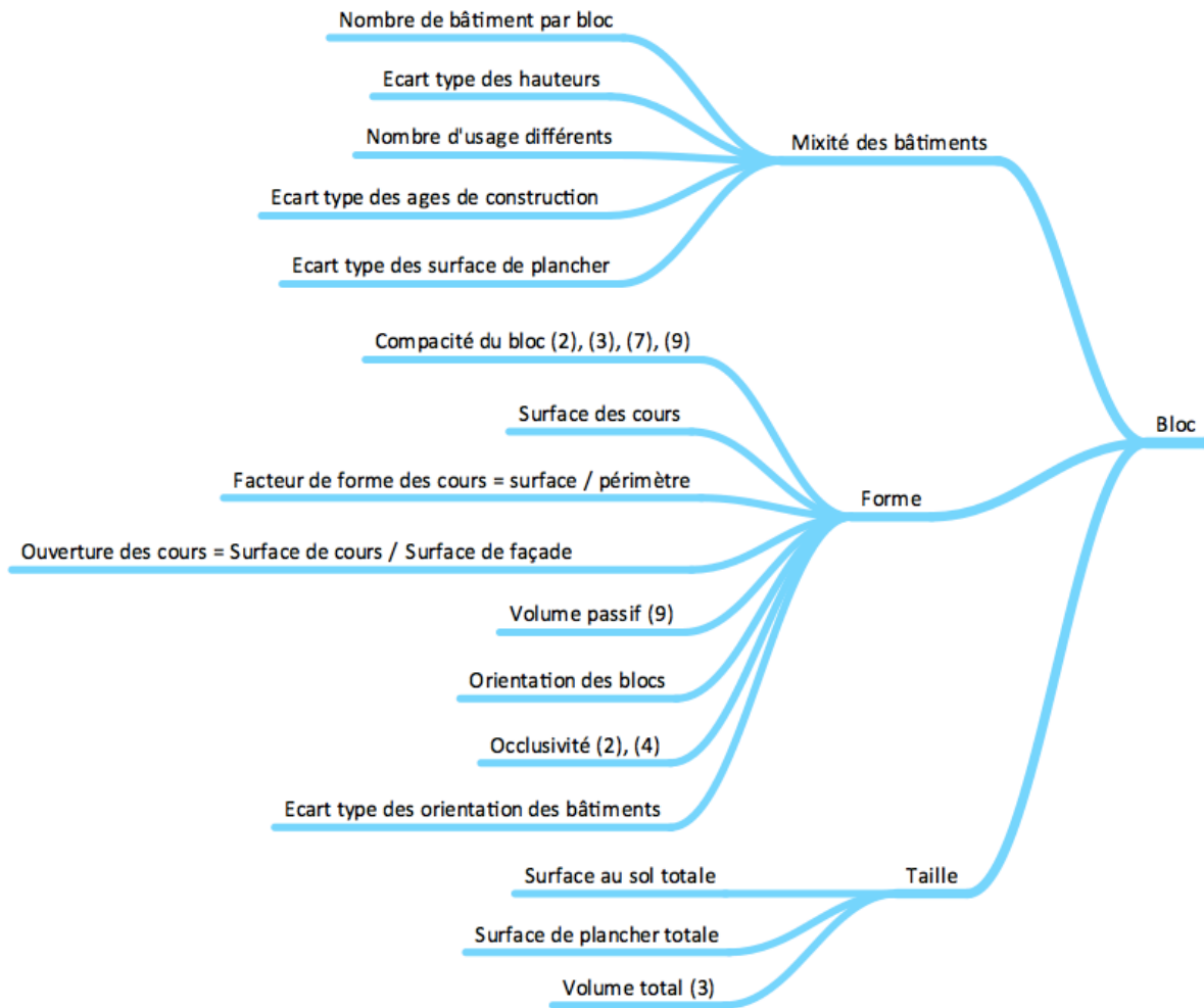
Figure 74 : Paramètres descriptifs d'une typologie urbaine – Axe « Bloc » (2) (Adolphe et al., 2002), (3) (Long & Kergomard, 2005), (4) (Fouad, 2007), (7) (Atelier Parisien d'URbanisme, 2007), et (9) (Salat, 2011a)
